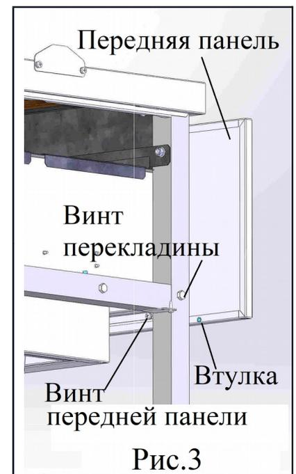
4.4 Снимите переднюю панель со станции, для чего выкрутите винты вдоль нижнего края с внутренней стороны станции, удерживающие ее (рис.3). Переставьте переключатель в нижние отверстия каркаса (рис.4).
