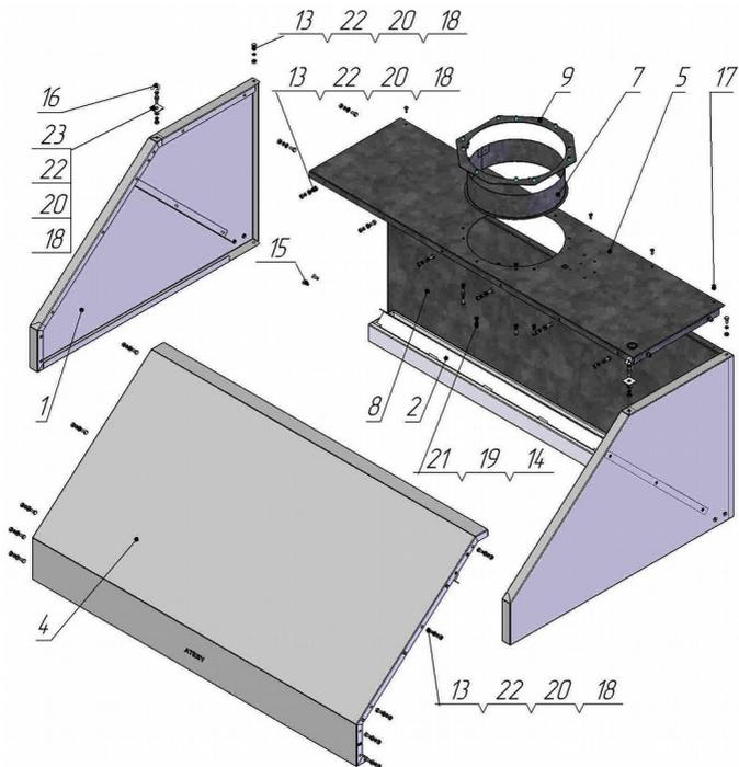
\* Темным цветом выделены детали из оцинкованной стали
